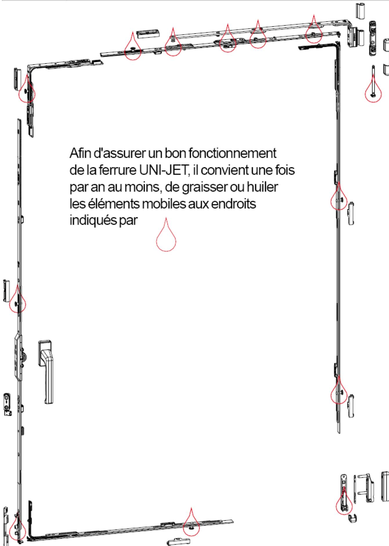
Afin d'assurer un bon fonctionnement de la ferrure UNI-JET, il convient une fois par an au moins, de graisser ou huiler les éléments mobiles aux endroits indiqués par
